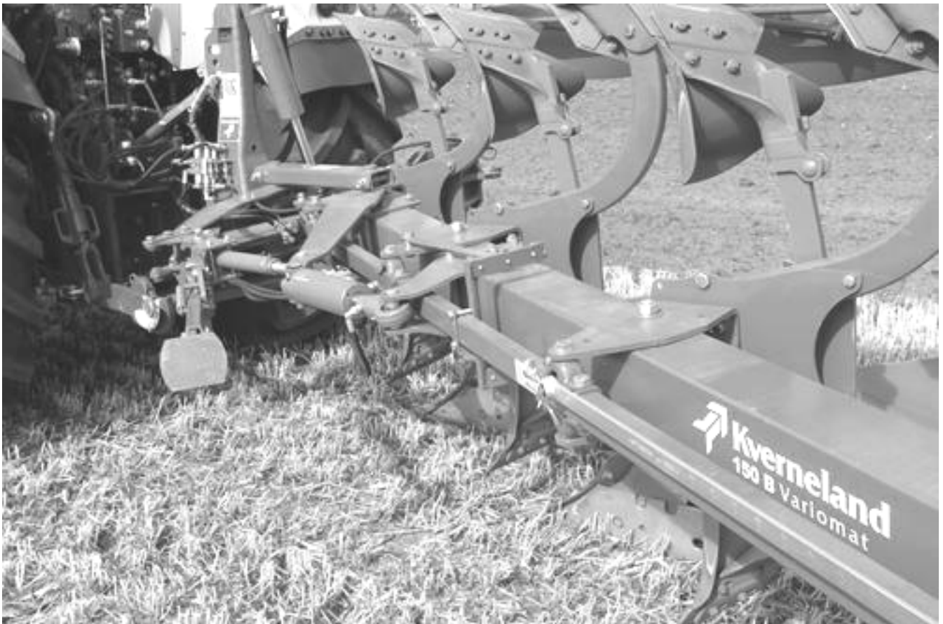
Vue de dessus d'une charrue pentasocs à largeur de travail variable (d'après document Kverneland).
